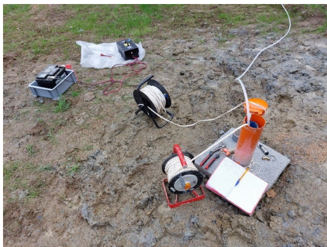
Pompage en cours sur un piézomètre du site
