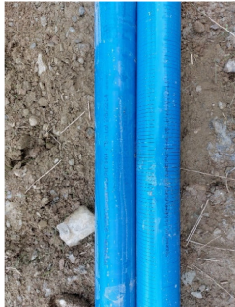
Tube plein et tube crépiné (diamètre 64/75 mm)
